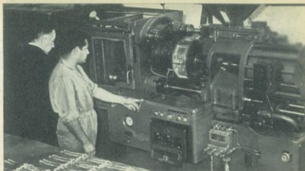
Esta es la máquina especial, dotada de troqueles, en la que la materia plástica que viene en grano, se convierte en pasta, entra en moldes y sale convertida en mangos de cepillos de dientes, con diversos modelos y vistosísimos colores.
